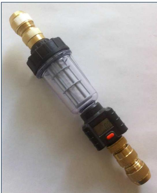
Il contaltri è lo strumento ideale per misurare le quantità d'acqua prelevate da una pompa durante le operazioni di spurgo e/o campionamento.
