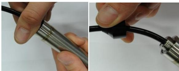
Fig. 42- Allentamento del dado di sicurezza e scorrimento all'indietro lungo il cavo
