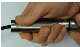
Fig. 43- Rimozione del tubo protettivo
