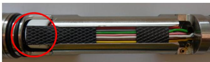
Fig. 45- Sostituzione dell'essiccante
